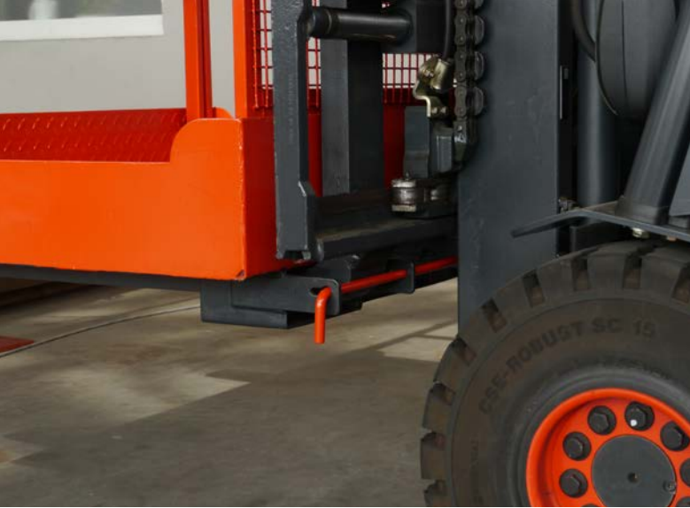
Abb. 2 Formschlüssige Befestigung der Arbeitsbühne
